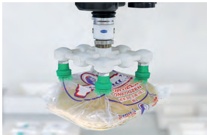
Sistema di presa con ventose a soffietto SPB4f per la movimentazione di confezioni in sacchetti con forte formazione di grinze e basso grado di riempimento
