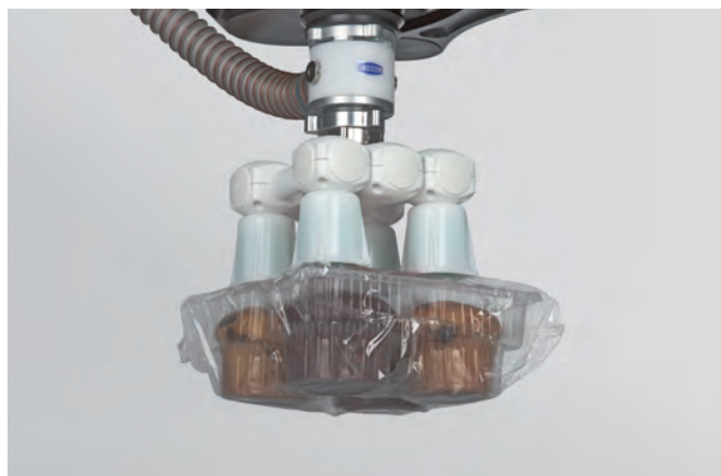
Sistema di presa con ventose a soffietto SPB4 ed elementi di stabilizzazione per la movimentazione di imballaggi labili flowwrap
